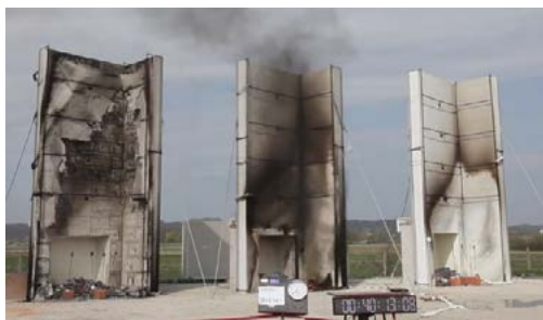
Slika 62 Tijek ispitivanja ponašanja različitih sustava pročelja
